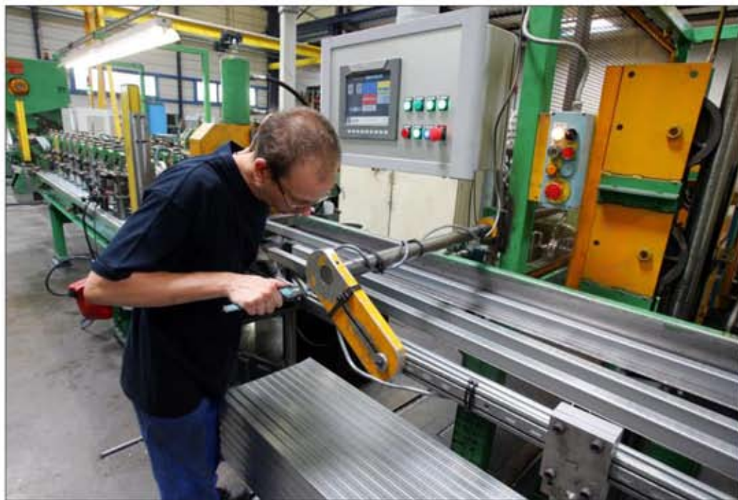
■ Les rails sont fabriqués à partir de bobines d'acier de deux tonnes
